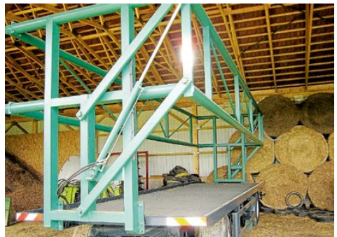
Durch hydraulische Bordwände ist ein Besteigen des Ballentransportwagens nicht mehr nötig.
